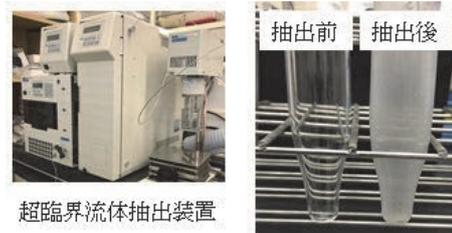
②は、還元法によるケラチン抽出工程であるが、従来法では疎水性アミノ酸側鎖と強固に相互作用している不純物の一部が最終抽出物まで残存していた。その結果、抽出ケラチンの再溶解性や成型工程にも影響を及ぼし、使用溶媒の選択制限や補助高分子等の共存による加工を余儀なくされ、純ケラチン（ケラチン100%）のみによる成型加工が困難であった。そこで本研究では、特定の有機溶媒を用いた抽出原液からの選択的不純物除去という新たな精製ステップを追加し、タンパク質の変性を起こさず、それを達成した。
