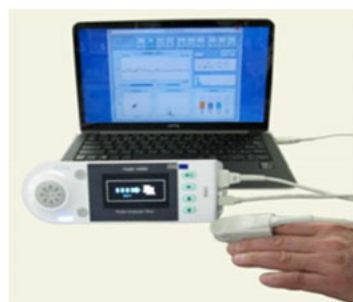
図2. 自律神経機能評価加速度脈波測定器 TAS9 VIEW
