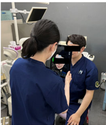
研究風景：非接触型三次元形状計測装置を手で持ち、顔貌のスキャンを行っている様子
