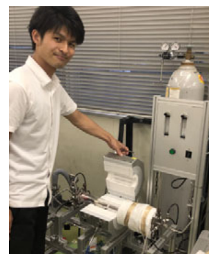
図 1. 自作の急冷機構付管状炉による実験の様子
