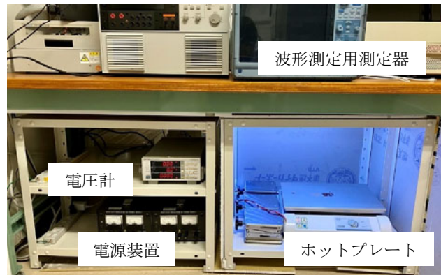
図 3. パワー半導体デバイスの寿命評価試験環境
