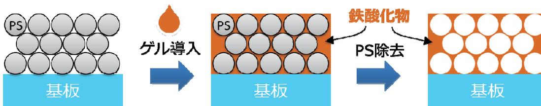
図1 PSの自己組織化→鉄酸化物ゲル導入→PS除去→鉄酸化物3D構造体。
