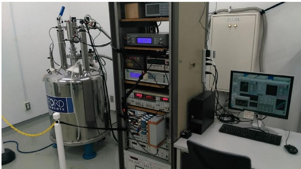
図2. 極低温・強磁場における比熱、および磁気熱量効果の測定システム
