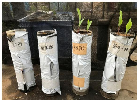
土壤微細構造の観察の為、ポット下層に 100 cm<sup>3</sup> のステンレスコアを打ち込み、不攪乱土壤を採取した。コア試料は凍結乾燥させ、不飽和ポリエステル樹脂で固化後、1 辺 5cm のブロックに切断し、土壤薄片を作製した。
